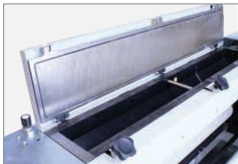
Réservoir en acier inoxydable avec un capteur de niveau bas et une capacité réduite pour éviter la dégradation de l'adhésif.
