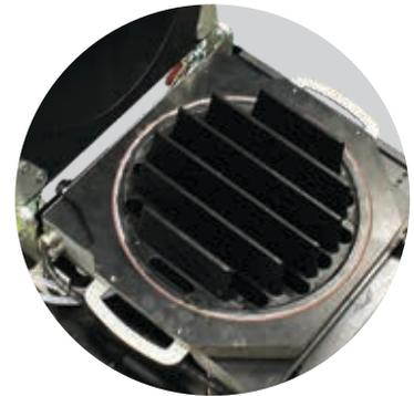
La nouvelle grille à ailettes avec chauffage intégré améliore les capacités de chauffage du réservoir pour une cadence de fonte 50 % supérieure.
