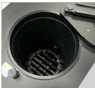
Les unités IsoMelt comportent un réservoir rond en Téflon® pour un nettoyage facile, avec un couvercle du réservoir hermétique pivotant. Le capteur de niveau bas intégré facilite le remplissage.
