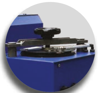
Ouverture du réservoir étanche à l'air et système de soufflage
