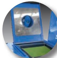
Le couvercle inclut un joint de réservoir qui limite la contamination et isole l'adhésif en fusion.
